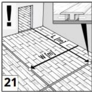
Para áreas de instalação com mais de **12 metros de comprimento ou largura, e em ambientes com muitos cantos ou condições climáticas variadas**, recomenda-se deixar vãos de expansão de pelo menos **2 cm de largura [21]**. Esses vãos permitem que o piso se expanda ou contraia devido às mudanças climáticas.
